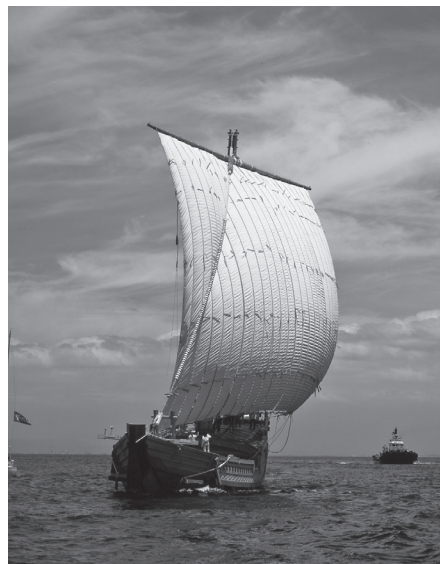
菱垣廻船「浪華丸」。かつて大阪市が復元した北前船が大坂湾を帆走する。帆の向こうの高い部分が舵楼(だろう)。(提供:大阪市港湾局)
